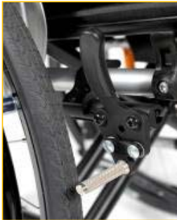
LFE060001 Feststellbremse Stossarretierung
